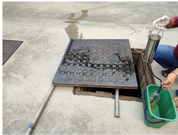
เก็บตัวอย่างน้ำทิ้งที่บ่อพักน้ำเสียหลังจากจากระบบบำบัดน้ำเสีย ด้วยวิธี Sampling Pump
